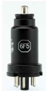
FIGURE 7 – Triode 6F5 utilisée dans les oscillateurs de l'Onde 169.
