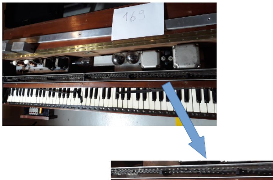
FIGURE 2 – Contrôles et circuit de l’Onde 169 et mise en évidence du condensateur variable - Musée de la Musique, Paris.
