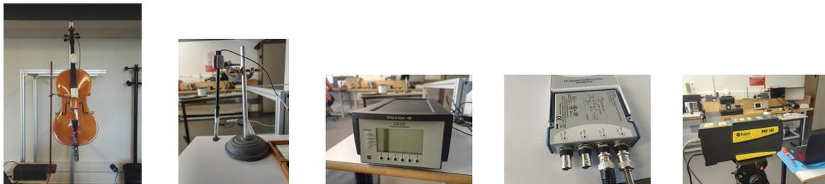
FIGURE 2.10 – Matériels utilisés. De gauche à droite : Support métallique, Marteaux d'impact B&K, Conditionneur B&K, Carte acquisition NI 9162
