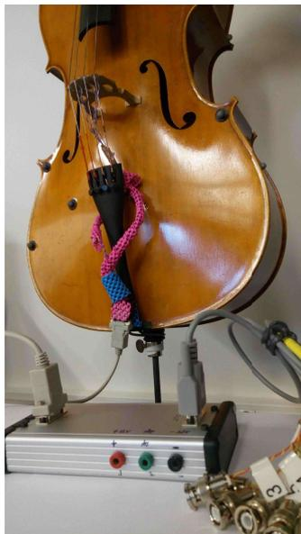
FIGURE 3.10 – Capteurs piézoélectrique placés sur chacune des cordes du violoncelle qui passe à travers un amplificateur avant d'être enregistré sur un ordinateur
