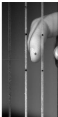
FIGURE 2.2 – Image issue de la caméra rapide, doigt index sur la corde Mib2 avec quatre marques sur les cordes et une marque sur le doigt.
