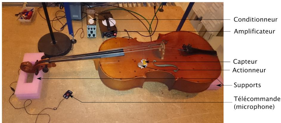
FIGURE 3.3.: Présentation du dispositif expérimental
