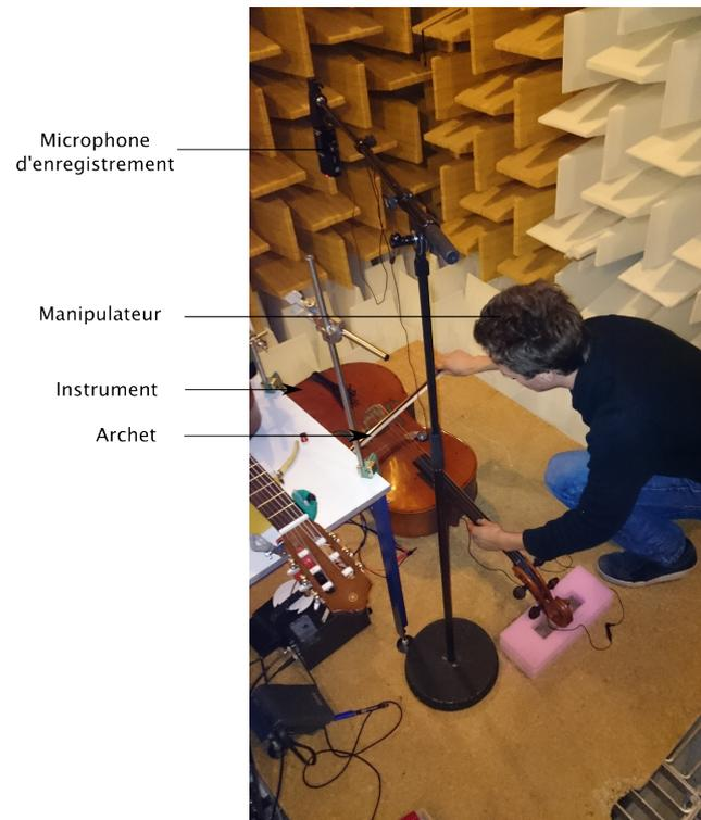
FIGURE 3.6.: Expérience réalisée avec une excitation due à l'archet
