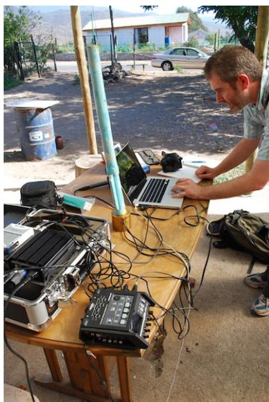
FIGURE 2.8 – Mesure d'impédance d'entrée d'une flûte puntera (Pucalan, Janvier 2011)
