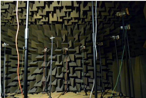
(a) Dispositif de restitution 2D élaboré dans le cadre du stage
