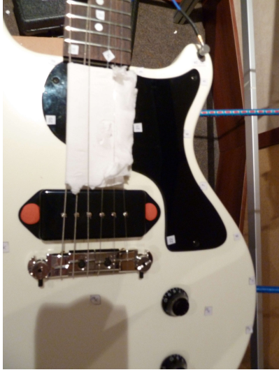
FIGURE 27 – Papier et pâte à modeler pour étouffer cordes et vis
