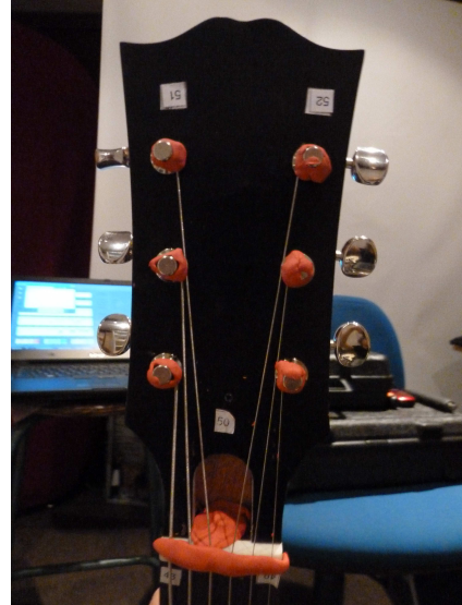
FIGURE 28 – Pâte à modeler pour étouffer cordes, mécaniques et truss-rod
