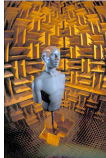
figure 6 : modèle de tête artificielle - mannequin KEMAR
