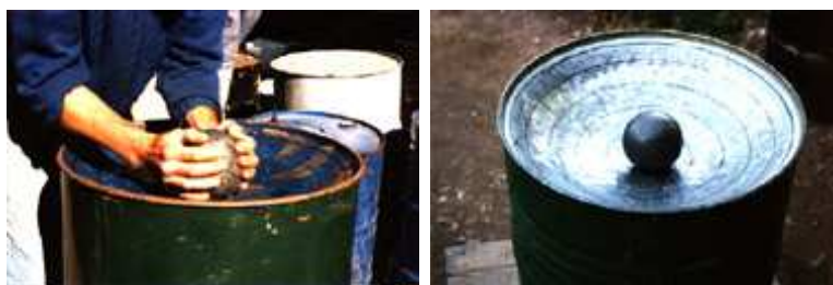
FIGURE 1.1 – Première étape : l'emboutissage du fut.
