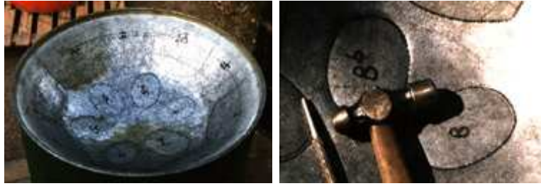
FIGURE 1.2 – Martelage entre chaque espace pré-dessiné et délimitation au poinçon grooving .
