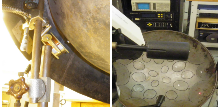
FIGURE 2.2 – Analyse modale expérimentale du Tenor : à gauche, excitation sinusoïdale du Steelpan par un système électromagnétique ; à droite mesure de la vibration au vibromètre LASER.
