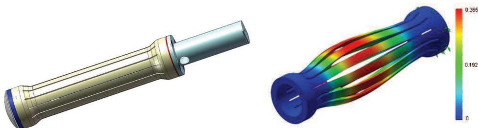
FIGURE 1.2 – Poignée vibrante et déformation sous la contrainte d’un actionneur piezo-electrique.
