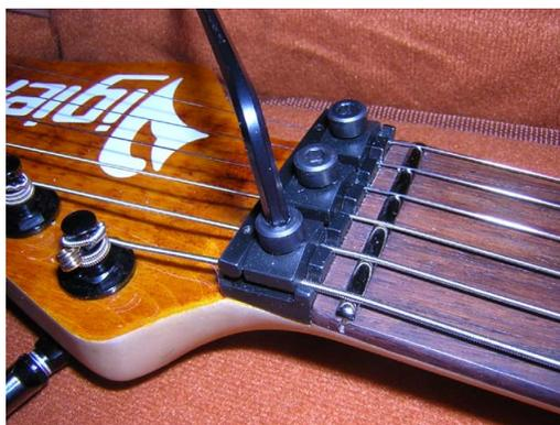
FIGURE 2 – Tête de guitare électrique avec bloque-cordes de marque Vigier ®
