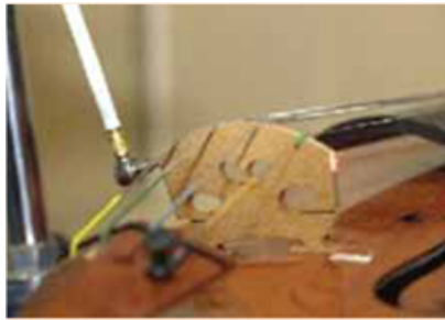
FIG. 2.2 – Marteau d’impulsion sur le chevalet
