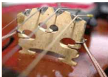
FIG. 2.1 – Capteurs piézo-électriques sur le chevalet, sous chacune des cordes
