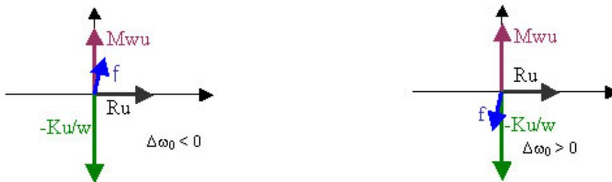
Figure 39 : diagramme de Fresnel : correction en fréquence avec retard pris en compte
