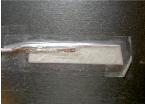
Figure 10a : le capteur (appliqué sur la lame)
