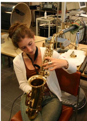
FIG. 2.2 – Mesure d'impédance d'entrée d'un saxophone alto à l'aide de la méthode TMTC.
