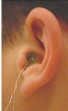
**Figure 19 : dispositif de mesure dit en "conduit bloqué"**
